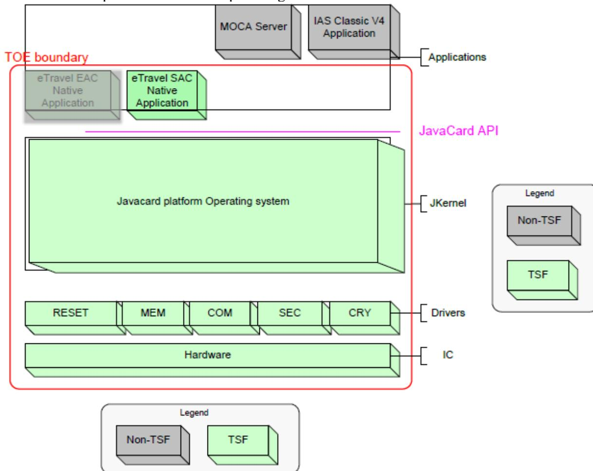
Figure 1 - Architecture et périmètre de la TOE
